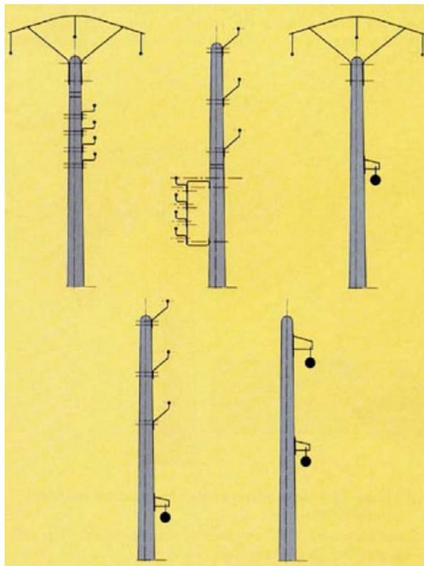
Figure 6 : Réseau électrique mixte HTA et BT
